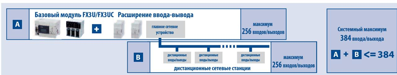
FX3U/FX3UC предлагает дополнительные входы и выходы, а также расширенные возможности сетевой коммуникации
