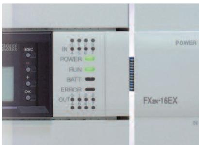
К базовому модулю FX3U можно подключить как новые модули FX3U, так и стандартные модули расширения серий FX0N и FX2N.
