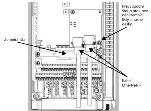
⑦ Uvolněte háčky na vnitřní straně krytu frekvenčního měniče pomocí kleští apod. a sejměte kryt předního výzevu.
